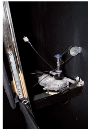
Eine Rahmen-/Seilkonstruktion regelt die Maskierung der Leinwand.
